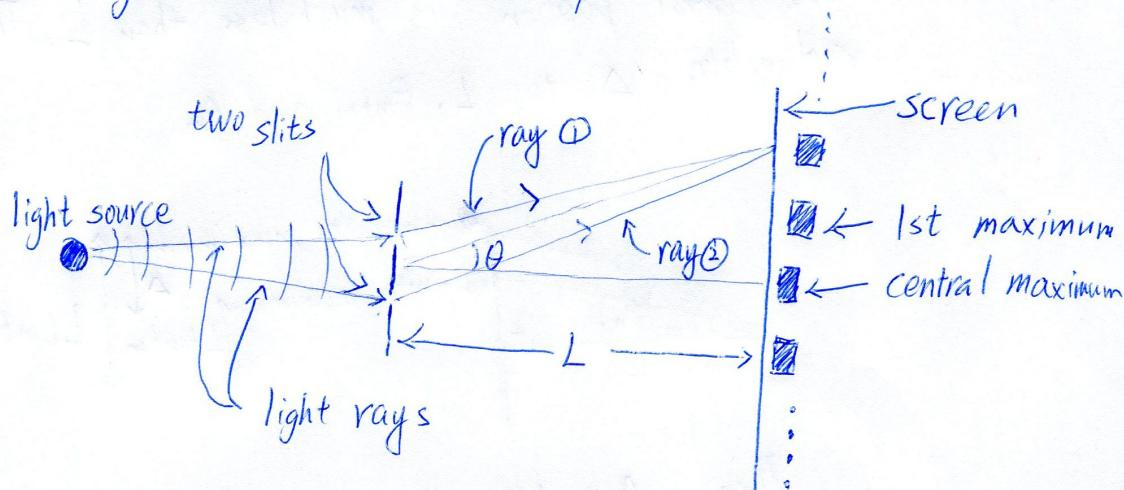
$d$ : slit separation     $L$ : slit-screen separation. ( $L \gg d$ ).
